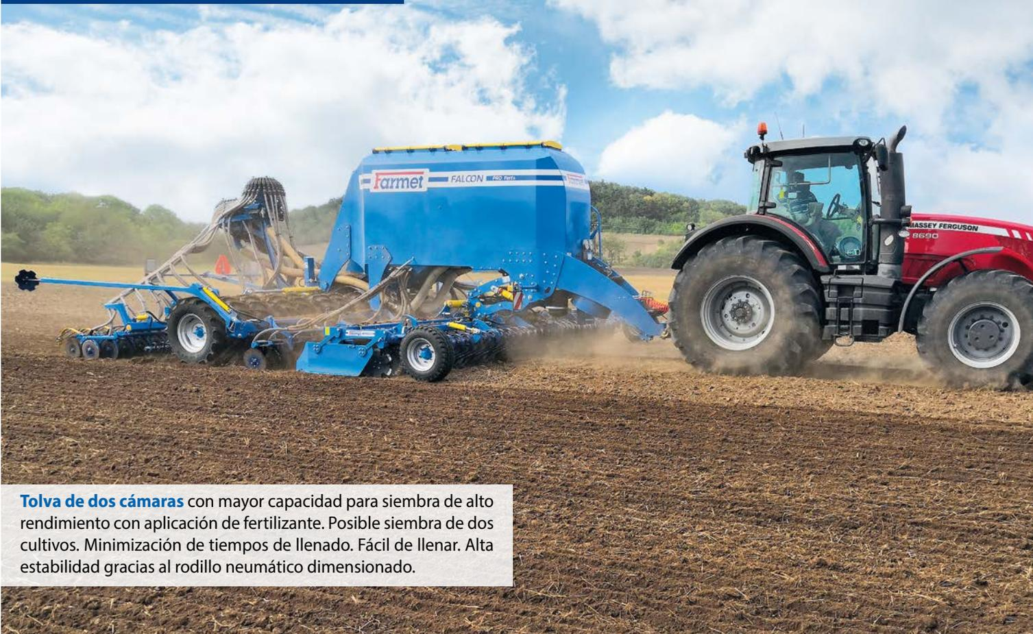
**Tolva de dos cámaras** con mayor capacidad para siembra de alto rendimiento con aplicación de fertilizante. Posible siembra de dos cultivos. Minimización de tiempos de llenado. Fácil de llenar. Alta estabilidad gracias al rodillo neumático dimensionado.
