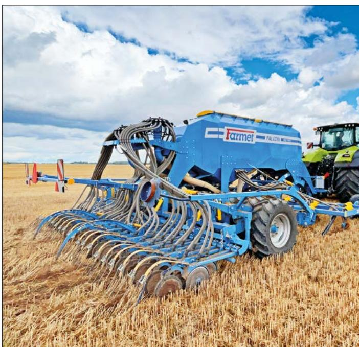
**VERSIÓN FERT+: EL FERTILIZANTE SE APLICA MEDIANTE UNIDADES DE FERTILIZACIÓN**
