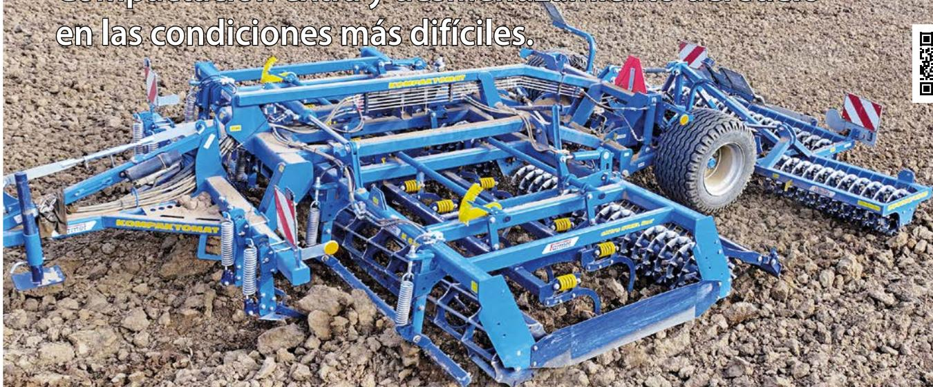
Los rodillos Crumbling son especialmente adecuados para mejorar el procesamiento del suelo con Kompaktomat. Se utilizan principalmente en suelos pesados, en temporadas de verano y otoño. Desmenuzan eficazmente los terrones.
