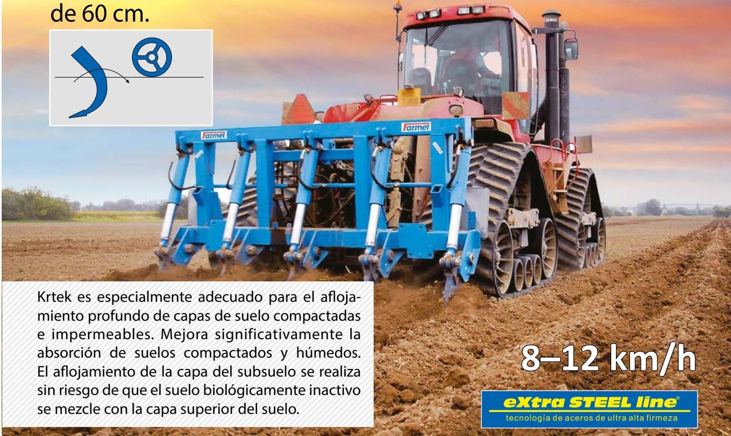
Krtek es especialmente adecuado para el aflojamiento profundo de capas de suelo compactadas e impermeables. Mejora significativamente la absorción de suelos compactados y húmedos. El aflojamiento de la capa del subsuelo se realiza sin riesgo de que el suelo biológicamente inactivo se mezcle con la capa superior del suelo.
