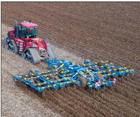
El cultivador modular semi montado de 5 filas Fantom PRO con baja resistencia en tiro y la profundidad variable del tratamiento del suelo es conveniente para trabajos de primavera, verano y otoño y gracias al sistema modular, puede empezarse pronto con los trabajos de primavera, ya que logra tratar hasta el suelo húmedo.
