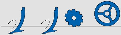
Los cultivadores de chisels Trioilent / Duolent son especialmente adecuados para el cultivo de rastros en toda la superficie con un efecto de mezcla intensivo. El suelo se trabaja hasta una profundidad de 35 cm y, por lo tanto, se puede sustituir el arado. Incorpora excelentemente los residuos de cultivos al suelo.
