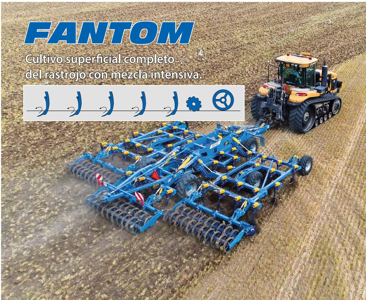
El cultivador Fantom es especialmente adecuado para la postcosecha en toda la superficie cultivo del rastrojo con un intenso efecto de mezclado. El suelo es labrado hasta el profundidad de 15 cm. Eso permite el cultivo del rastrojo, labranza y preparativos de pre-siembra.
