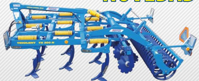
Versión con ajuste hidráulico de la profundidad de trabajo
