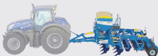
Digger P Fert+ COMPACT дышло и задний каток, встроенный бункер для удобрений, внесение удобрений на 2 уровня
