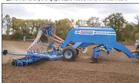
Высевальная планка с большой шириной обработки для посева культур с узкими междурядьями.
