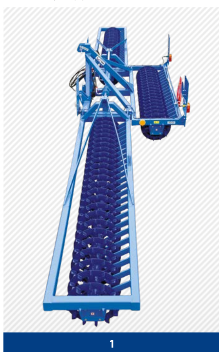
1. Бережная обработка поля перед посевом – измельчение комьев.
