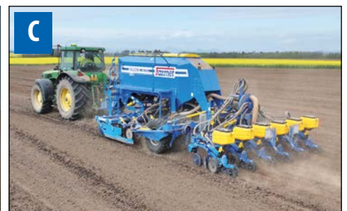
С Точный высев кукурузы с внесением удобрений.
