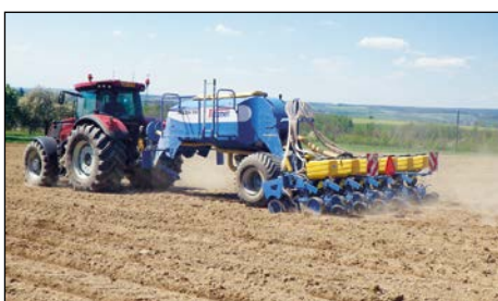
Навесна сеялка за сеитба на широкоредови култури.
