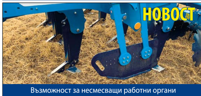
Възможност за повдигане на един ред работни органи при тежки условия.
