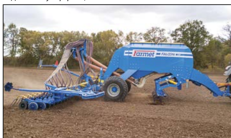
Висівачий брус з великою шириною захвату для посіву культур із вузькими міжряддями.
