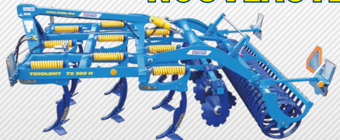
Variante avec réglage hydraulique de la profondeur de travail
