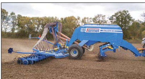
Section de semis large pour semer des cultures en rangs étroits.
