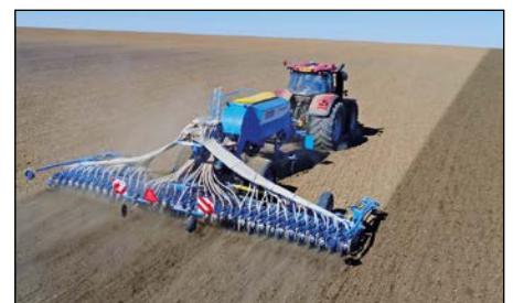
Section de semis large pour semer des cultures en rangs étroits.
