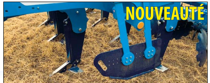
Possibilité de socs non-mulching.
