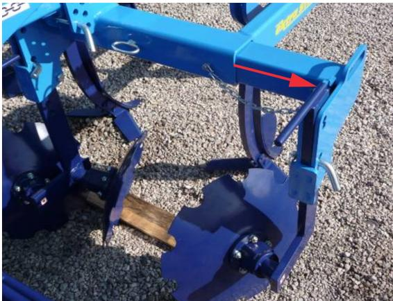
Fig. 3 - disques latéraux amovibles en position de transport
