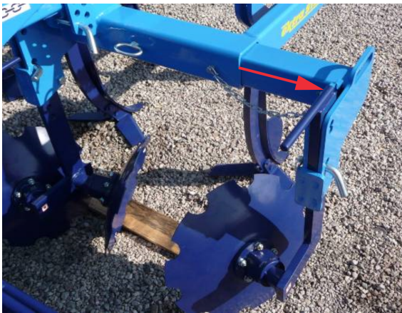
Rys. 3 - boczne wysuwne dyski w pozycji roboczej
