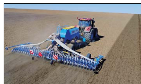
Plata darba platuma sēšanas sekcija šauru rindu kultūru sējai
