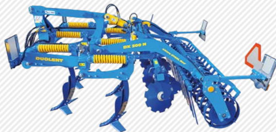
Versija ar hidraulisku darba dziļuma iestatišanu.
