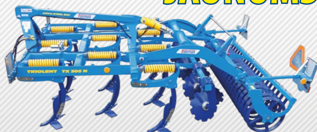
Versija ar hidraulisku darba dziļuma iestatišanu.
