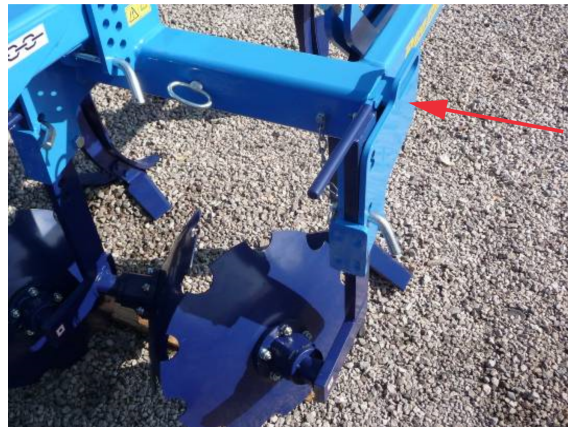
Obr. 5 - zadní dvojitý válec v přepravní poloze
