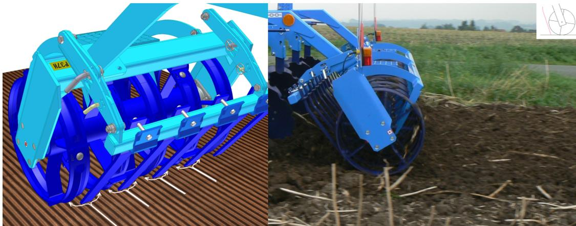
2. Передние боронующие лопатки, размещенные между колёсами катка, разбрасывают землю внутри колёс. Тем самым комки частично измельчаются под колёсами, а частично измельчаются внутри колёс. При такой настройке поверхность после обработки покрывается слоем измельченной земли.
