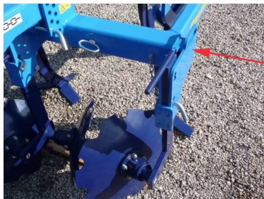
Рис.5 - задний двойной каток в рабочем положении
