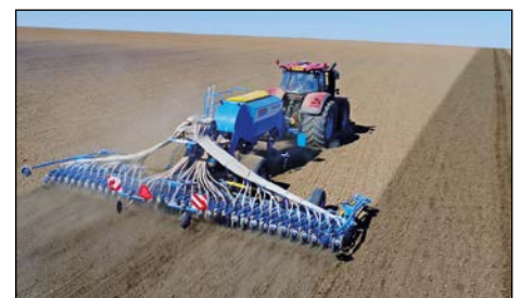
Широка сеитбена секция за засяване на тесноредови култури.
