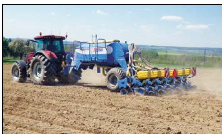
Навесна сеялка за сеитба на широкоредови култури.
