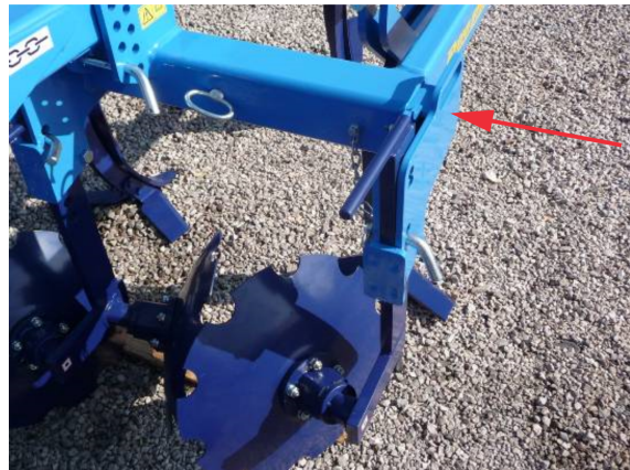
Abb. 5 - hintere, doppelte Walze in Transportlage
