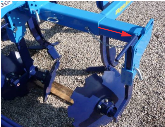
Abb. 4 - hintere, doppelte Walze in Arbeitslage
