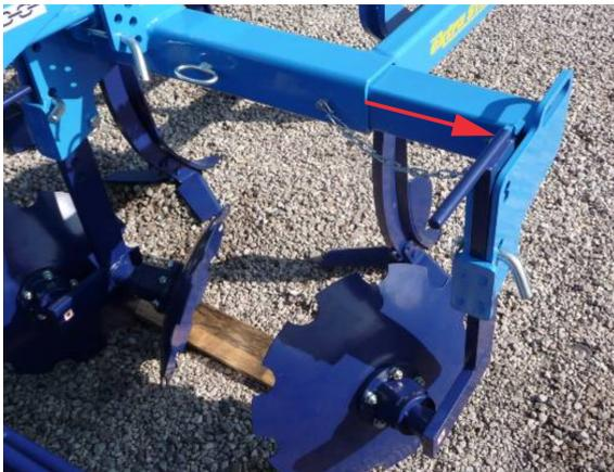
Fig. 4 - disques latéraux amovibles en position de transport
