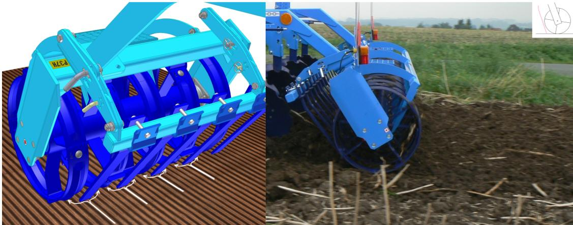
2. Les ailettes de nivellement avant, situées entre les roues du rouleau, répartissent la terre vers l'intérieur des roues. Les mottes sont donc partiellement désagrégées sous les roues et partiellement à l'intérieur des roues. Lors d'un tel réglage, la surface travaillée sera recouverte d'une terre fine.
