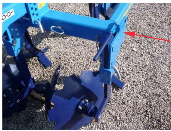
Fig. 5 - rouleau double arrière en position de travail
