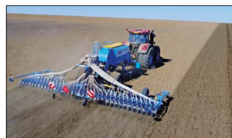
Secțiuni de semănat pe rânduri largi pentru semănatul culturilor pe rânduri înguste.
