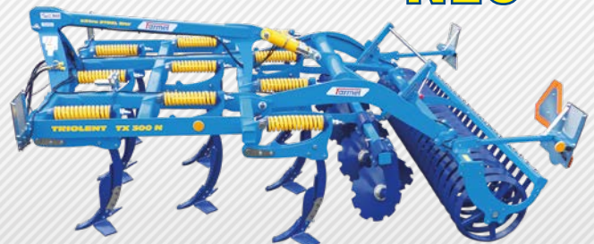
Variante mit hydraulischer Arbeitstiefenverstellung
