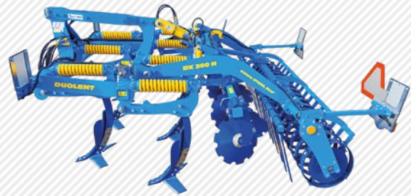
Variante mit hydraulischer Arbeitstiefenverstellung
