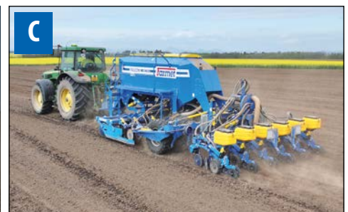
C Genaue Maisaussaat durch Düngungsapplikation
