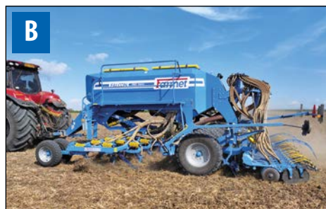
B Rapsaussaat mit einer tiefen Lockerung durch Düngungsapplikation
