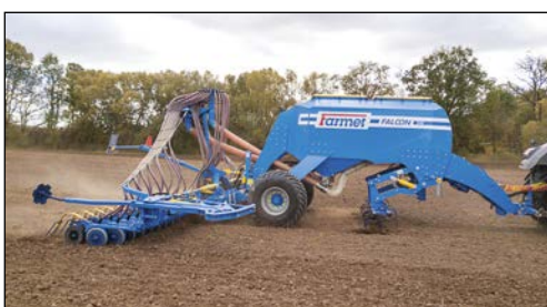
Aussaatleiste mit großer Arbeitsbreite für die Aussaat von Früchten in schmalen Reihen.
