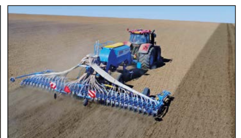
Breitsaat Säsektion für die Aussaat von schmalreihigen Kulturen.
