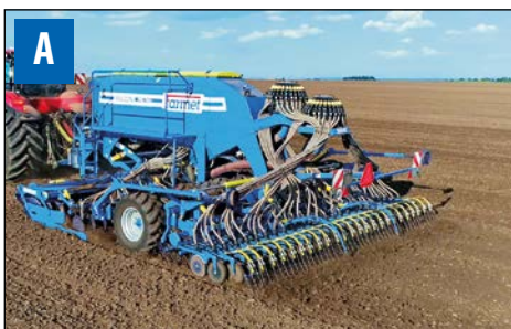
A Getreideaussaat in die engen Reihen mit der Möglichkeit von Unterfussdüngung
