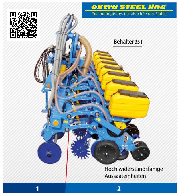
1. Zudüngung mit Scheibeneinheiten. 2. Präzisionsaussateinheiten.
